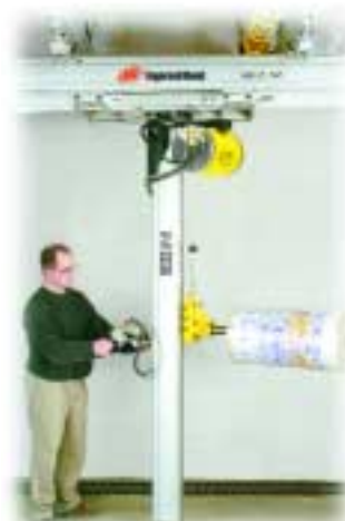
Rollentransportsystem mit kraftbetriebener Kippfunktion
