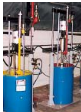
Extrúzne čerpadlá a príslušenstvo sa používajú pre husté novinové tlačiarenske hmoty.
