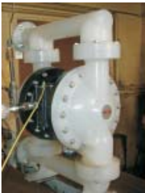
Čerpadlo rady EXP nahradilo konkurenčný model z dôvodu zníženej spotreby vzduchu
