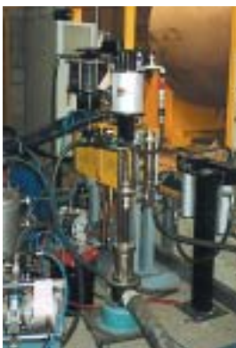
Piestové a membránové čerpadlá pre dvojzložkové farbiace stroje.
