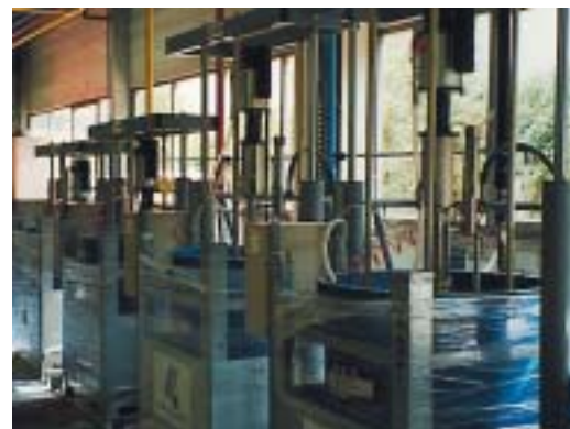
Špeciálne zostavy extrúzných čerpadiel pre veľkoobjemovú dodávku tlačiarenských (offsetových farieb).
